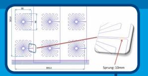
Alle Modelle unter Verwendung gestickter Sensoren in laminiertem GFK-Material.
